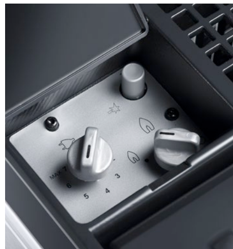
3-stupňová regulácia plameňa v režime na plyn, piezo zapalovanie, termostatická regulácia v režime 230 V
